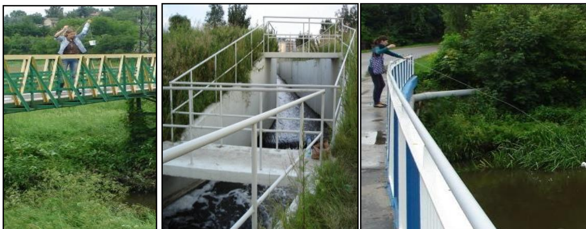
Rysunek 1. Punkty poboru prób (od lewej): nr 1 - pobór wody rzecznej przed zrzutem ścieków, nr 2 - zrzut oczyszczonych ścieków odprowadzanych z oczyszczalni „Hajdów”, nr 3 - pobór wody rzecznej za zrzutem ścieków.
